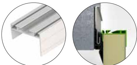
4 Le profil inférieur développé spécialement pour le dessous d'un panneau standard, supprime tous les ponts thermiques entre l'intérieur et l'extérieur de la porte. Un caoutchouc en bas, qui est glissé dans le profil, empêche l'air de passer sous la porte.
